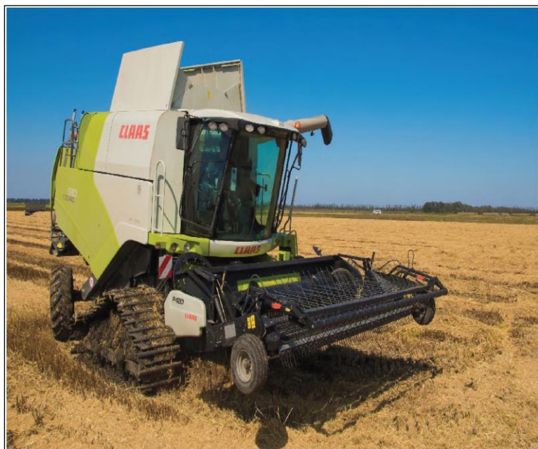
Рисунок 26 – Комбайн зерноуборочный TUCANO 580, оборудованный для уборки риса, с подборщиком P420
