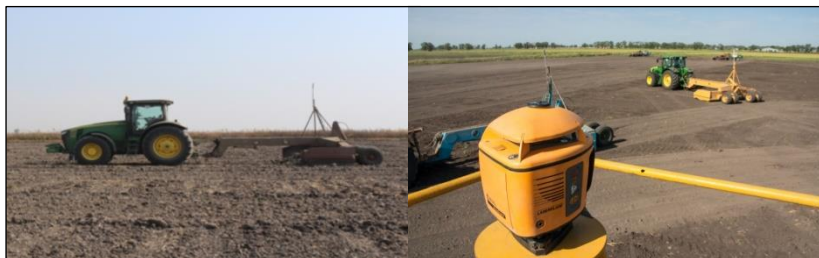
Рисунок 22 – Планировка чека с использованием лазерных систем
