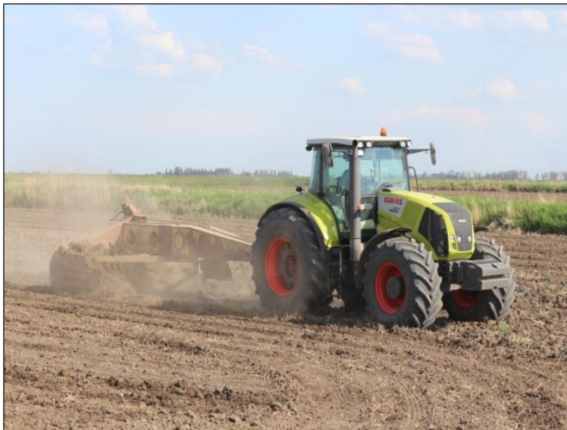
Рисунок 21 – Трактор CLAAS Axion на выравнивании чека
