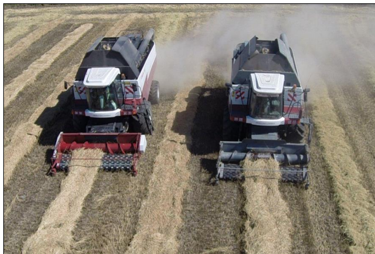
Рисунок 24 – Комбайны семейства Тогит на уборке риса двухфазным комбайнированием
