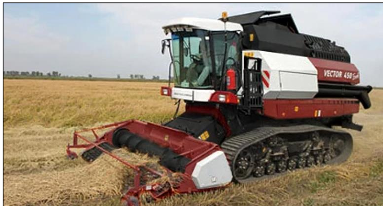
Рисунок 25 – Комбайн VECTOR 450 Track с платформой-подборщиком Swa Pick-340
