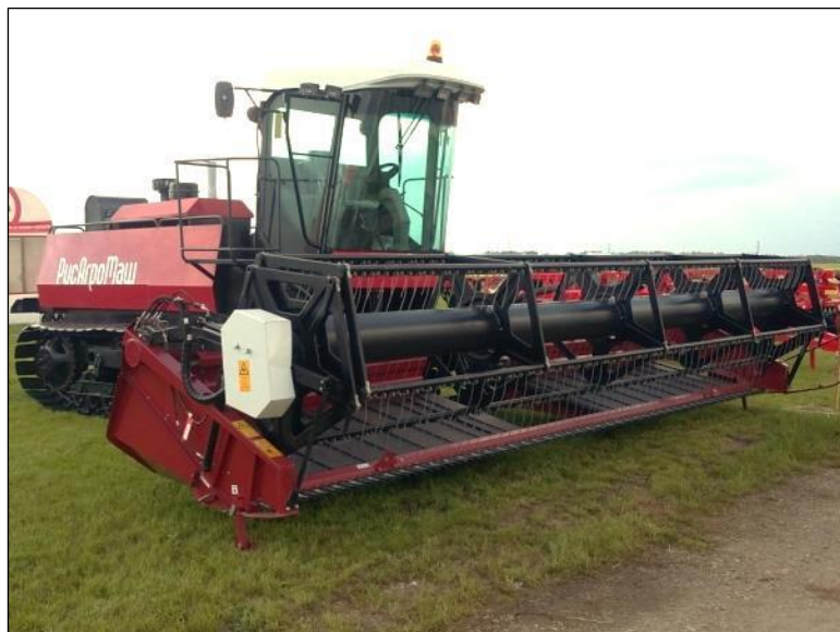
Рисунок 23 – Самоходный модуль ГМ-100 с жаткой ЖВР-5
