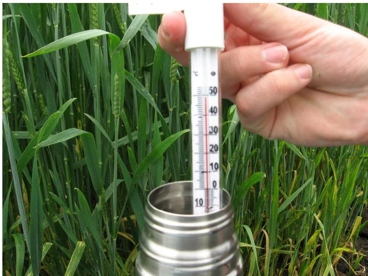
Рисунок 4.1 - Проверка температуры рабочей жидкости
