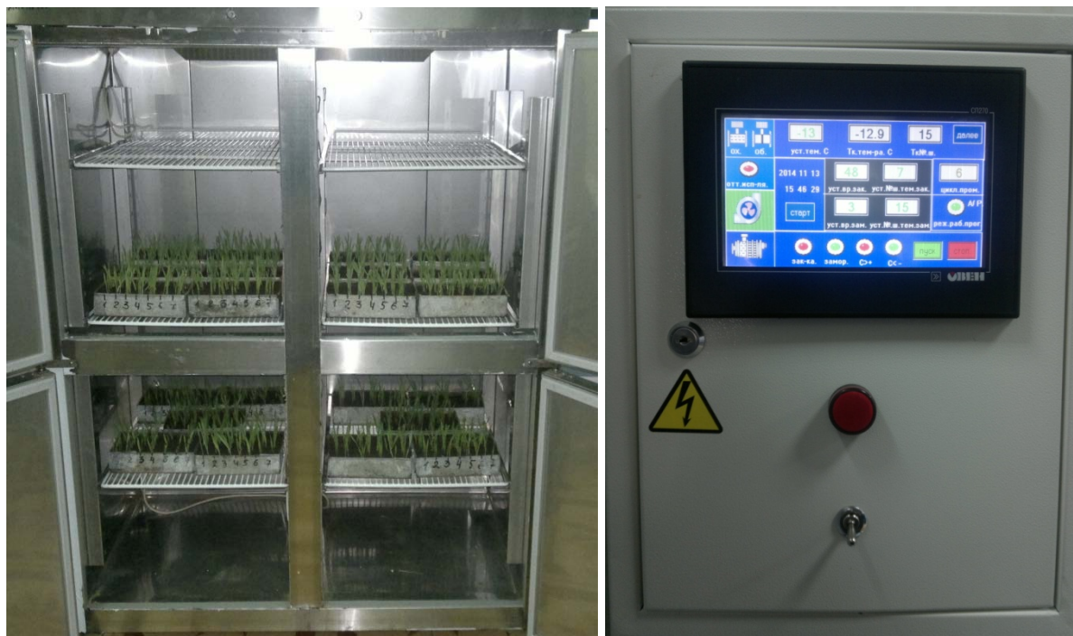
Рисунок 10 – Морозильная камера ЕКСI и програматор для гибкой системы регулирования температуры промораживания.
