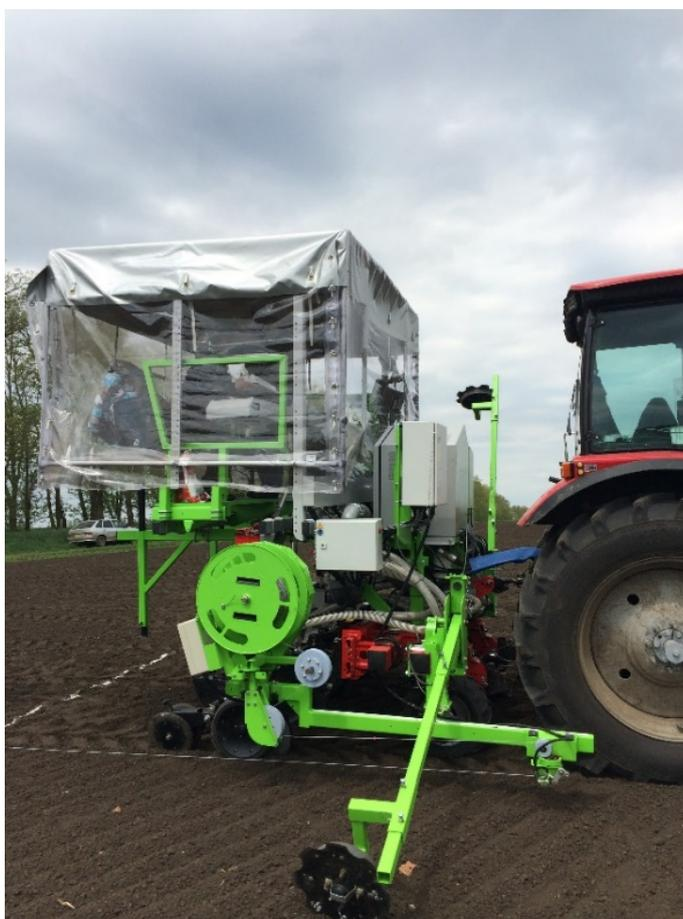
Рисунок 2.3 – Селекционная сеялка Dynamic Disc
