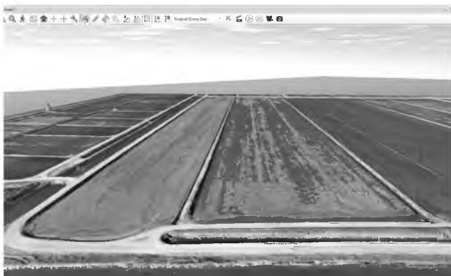
Рисунок 12. Фрагмент цифровой модели местности (DEM). Разрешение – 2,0 см/пикс (ВНИИ риса. Аэрофотосъемка БПЛА 28.05.2018 г.)
