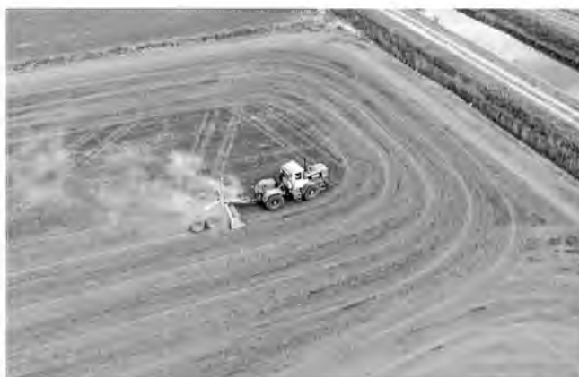
Рисунок 2. Планировка рисового чека с применением спутниковой системы — TOPCON (ВНИИ риса 12–14 мая 2018 г.)
