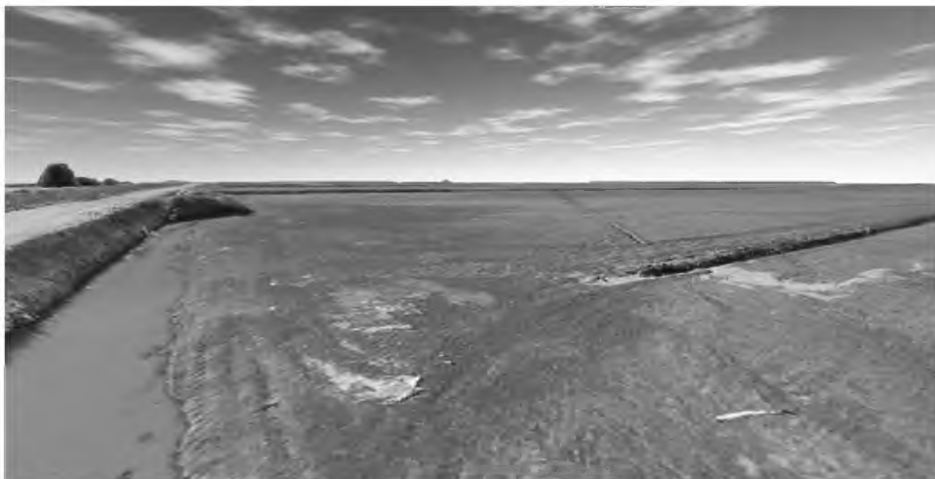
Рисунок 11. Увеличенный фрагмент цифровой модели местности (DEM) с верхним слоем растрового ортофотоплана. Разрешающая способность – 2,0 см/пикс. ГИС-приложение Global Mapper. (ВНИИ риса. Аэрофотосъемка БПЛА 28.05.2018 г.)
