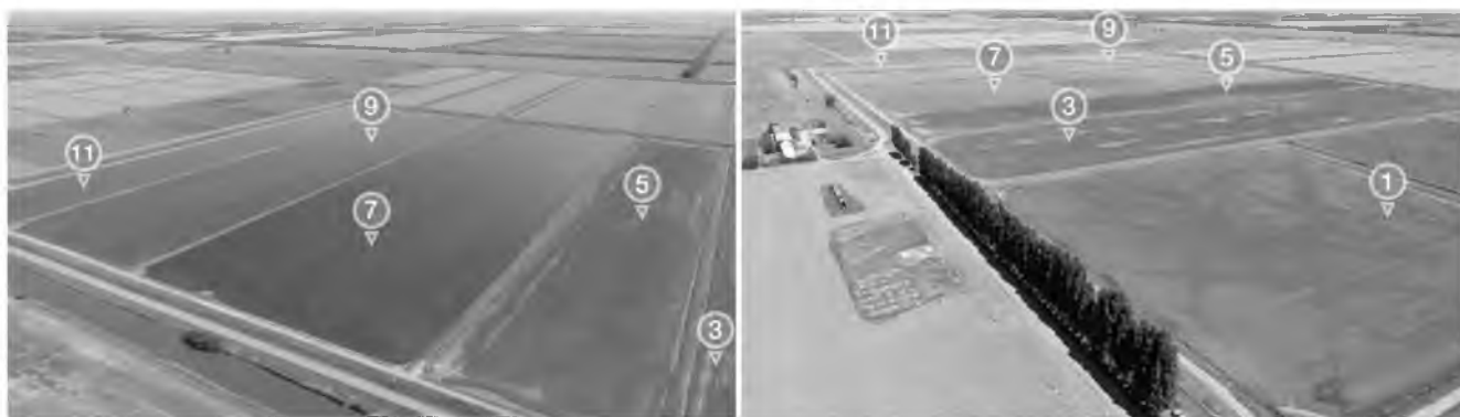
Рисунок 7. Полностью затопленные водой карта-чеки 7, 9, 11 (на четвертый день). На карта-чеках 1, 3, 5 завершен сброс воды. На карте 3, в понижениях, остались участки, заполненные водой. (ВНИИ риса. Видеосъемка БПЛА 21.05.2018 г.)
