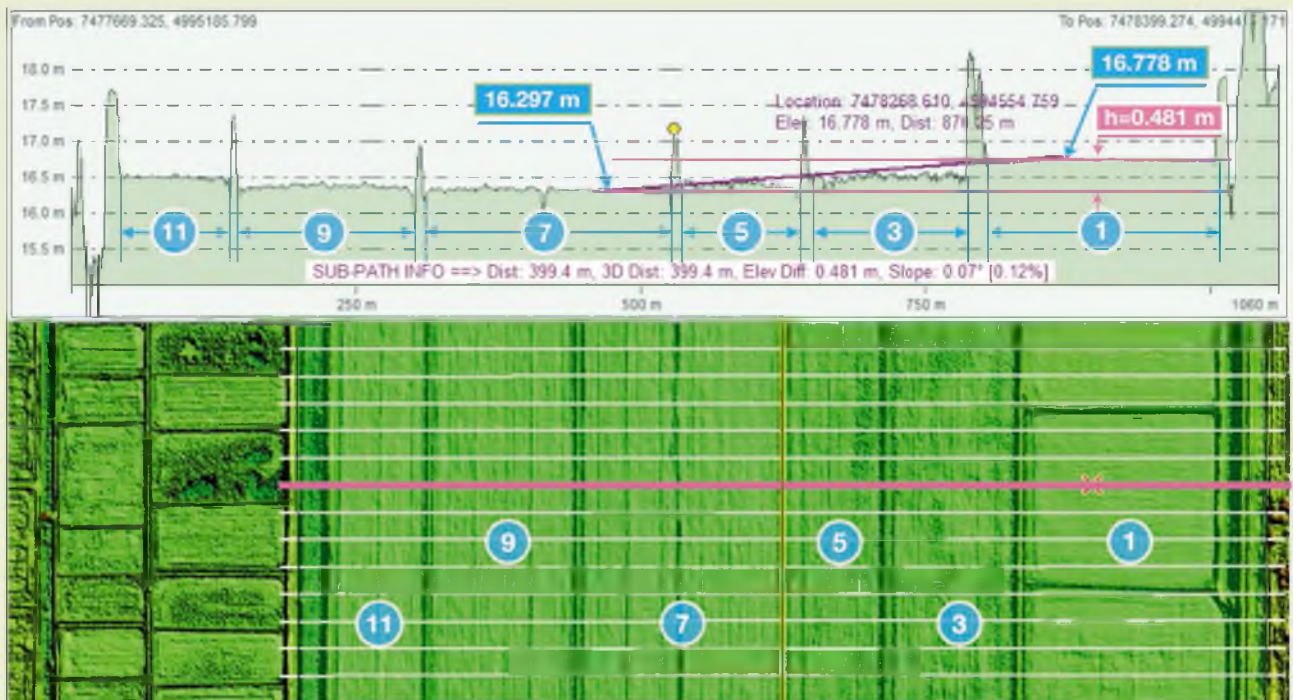
Рисунок 18. ГИС-приложение Global Mapper. Красным цветом выделен профильный разрез с минимальным перепадом высот между самым высоким уровнем поля — карта 1 и самым низким уровнем поля — карта 7. (ВНИИ риса. Аэрофотосъемка БПЛА 28.05.2018 г.)
