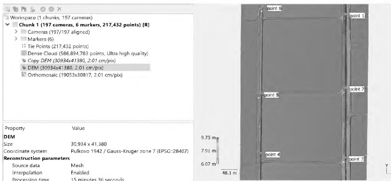
Рисунок 1. Цифровая модель местности (DEM) с максимальной разрешающей способностью 2 см/pix
