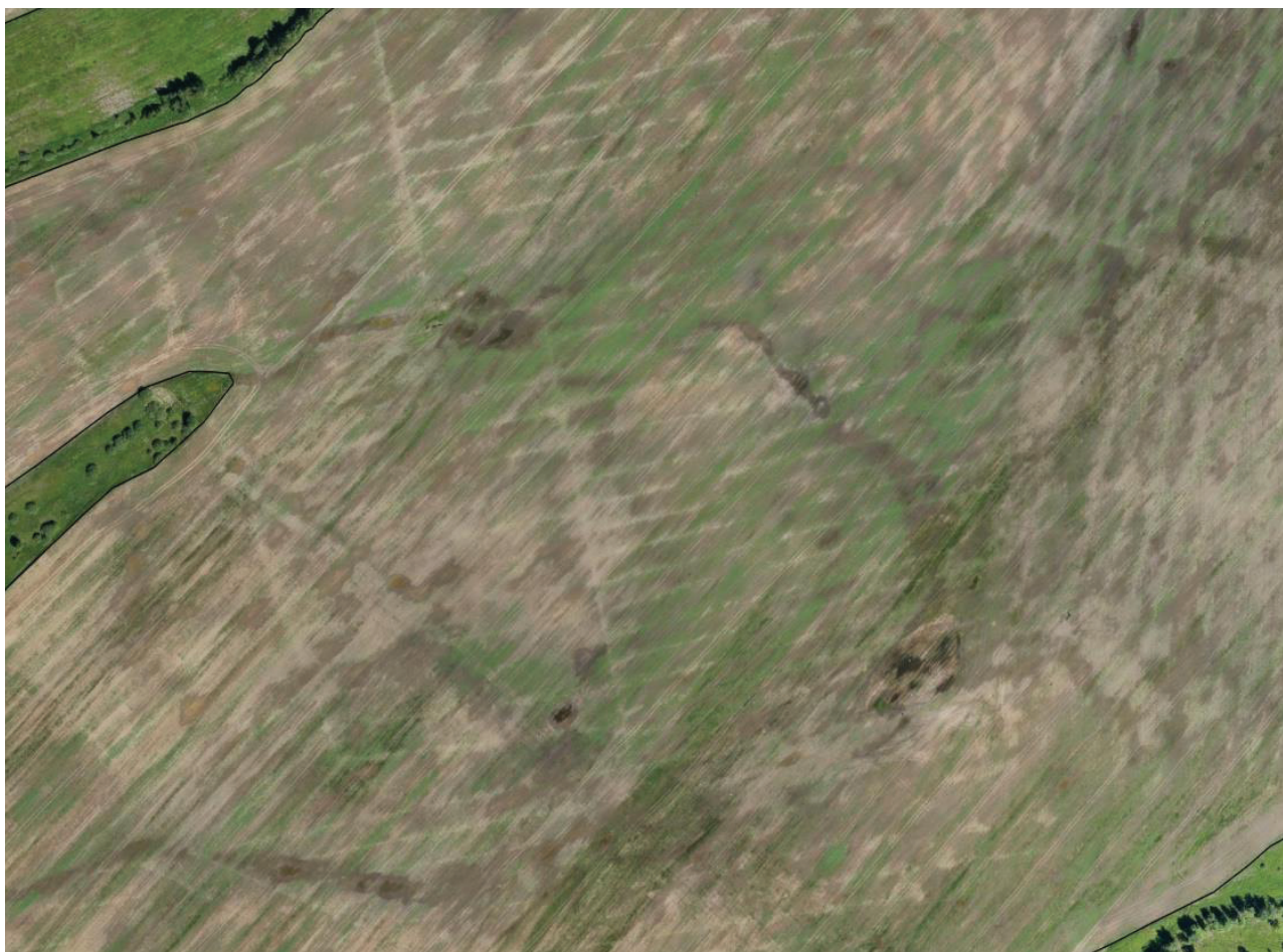
Рисунок 1. Фрагмент сельскохозяйственного поля с осушительной дренажной системой
