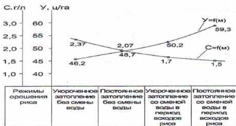
Рис. Влияние режима орошения риса на минерализацию воды в рисовых чеках в период всходов растений (С) и урожайность культуры (У)
