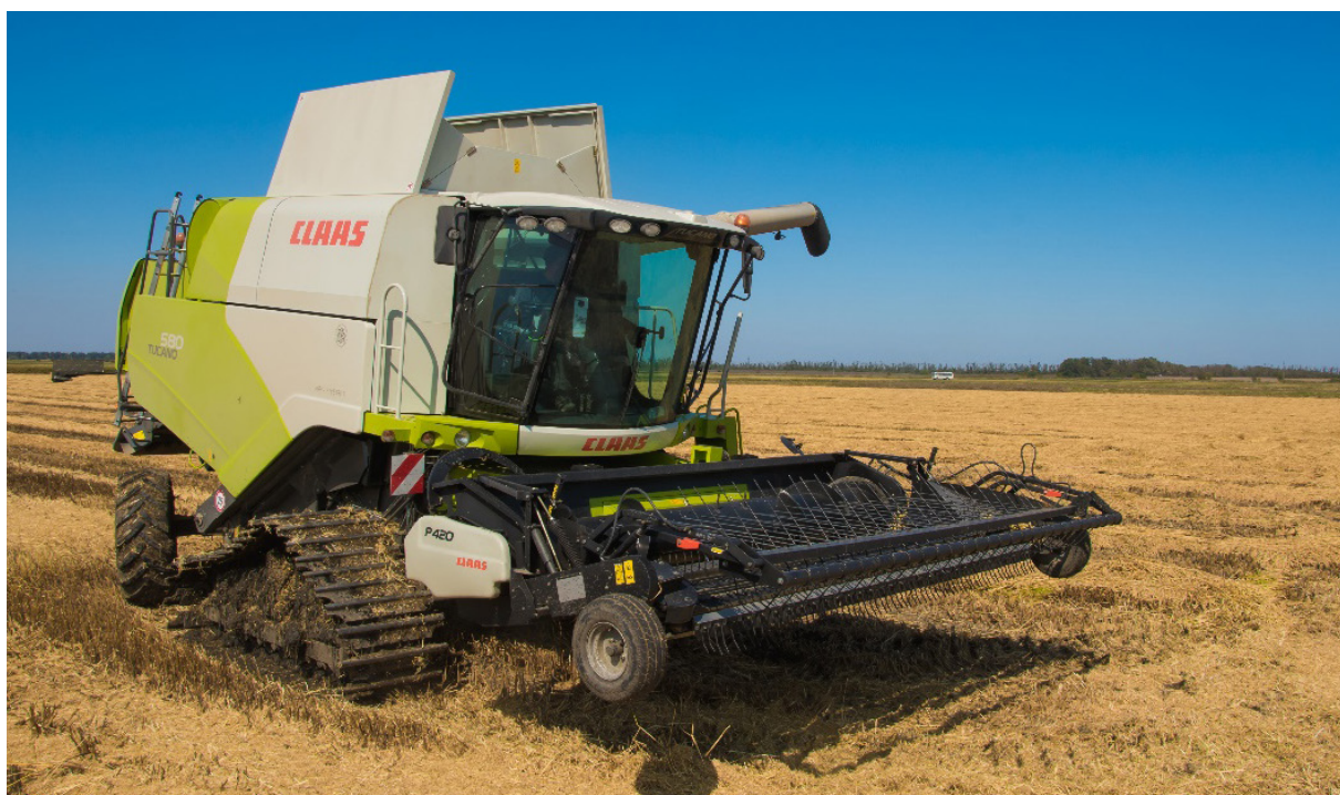
Рисунок 1. Комбайн зерноуборочный TUCANO 580, оборудованный для уборки риса, с подборщиком P420
